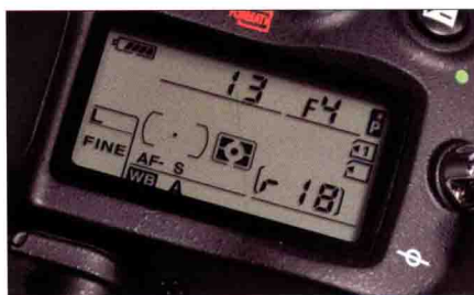
▲ 半按快门释放按钮时，除进行自动对焦和锁定外，也可显示相机的可连续的拍摄张数，根据所使用的图像品质和格式而不同。
