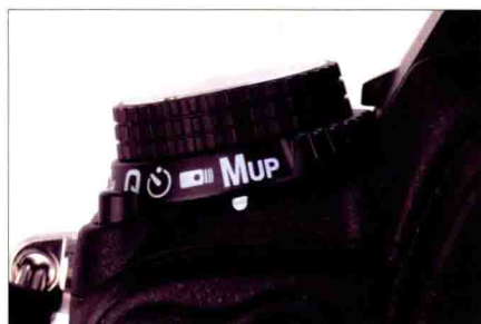
▲ 把释放模式转盘拨至“Mup”,便可在第一次按快门时令反光板升起锁定,然后再按快门正式拍摄。
