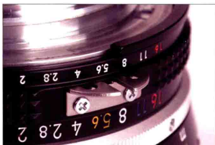
▲ 即使使用没有CPU的镜头,只要光圈环设有联动测光耦合杆的卡位,也能作测光表联动及自动曝光拍摄。
