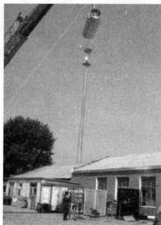
图 1-8 10m 高度的跌落试验
