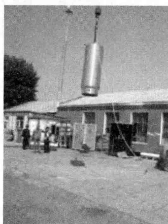
图 1-9 气瓶口侧 3m 高的跌落试验
