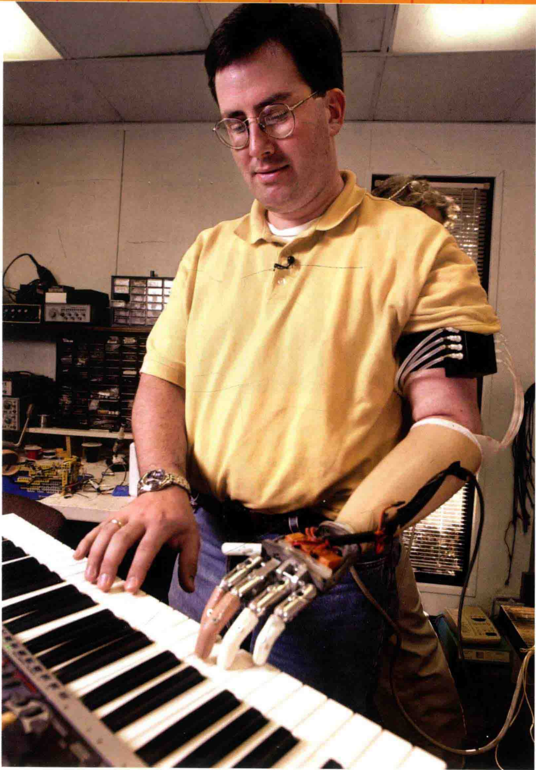
▲ 杰·斯基勒用仿生手弹电子琴。这只仿生手是罗格斯大学研制的，斯基勒的神经发出信号，电极接收后，指挥假肢中的马达。
