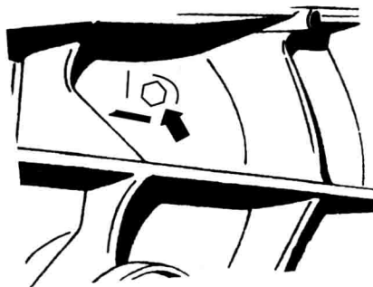
图 1—12 拧紧分离叉轴的定位螺栓
