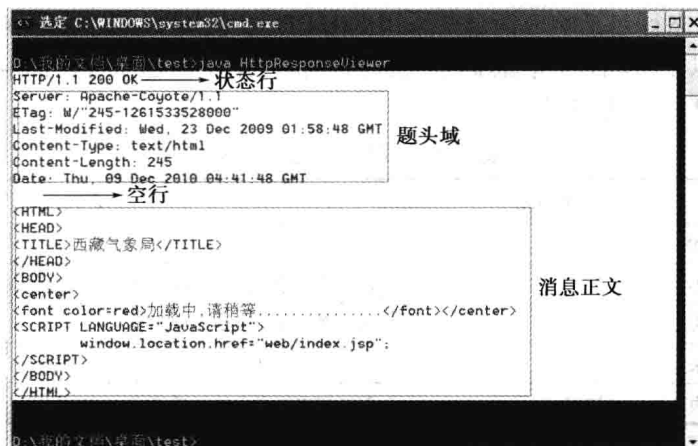
图 1-4 HTTP 响应消息格式
