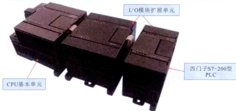
【图1-1 根据结构形式分类的PLC】
