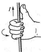
图 1-8 通电直导线的磁场方向
