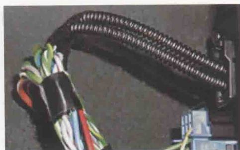
图5-38 波形管弯曲应避免半径不足
