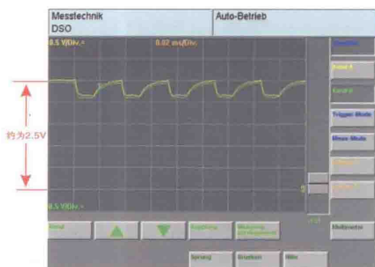
图2-42 CAN高线与CAN低线间短路
