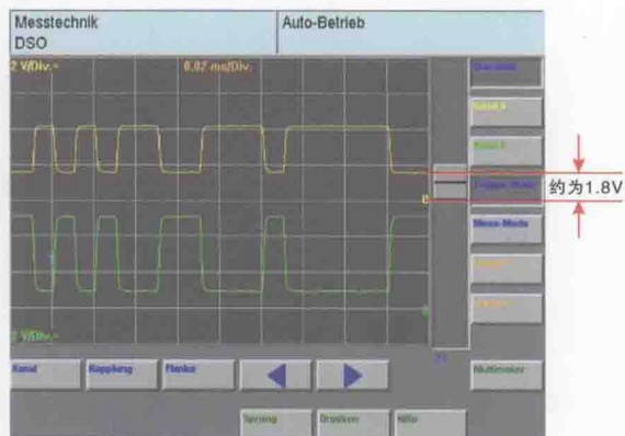
图3-35 CAN高线与正极之间通过连接电阻短路
