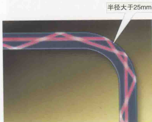
图5-15 光波在弯曲光导纤维中的传导
