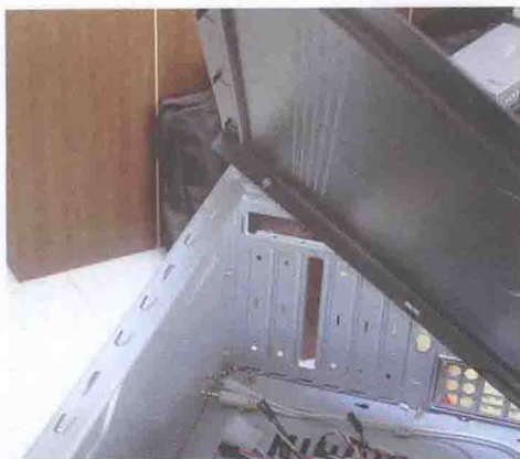
图 1-17 机箱侧板倒钩和箱体的钩槽
