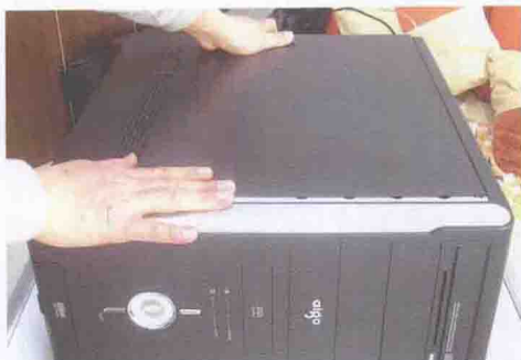
图 1-16 向机箱侧后方推动侧板并取出
