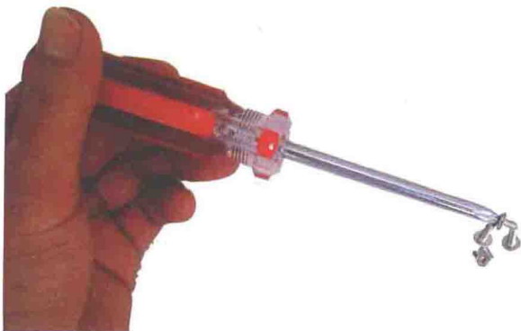
图 1-3 选择经过磁化处理的螺丝刀可以吸附各种小螺丝
