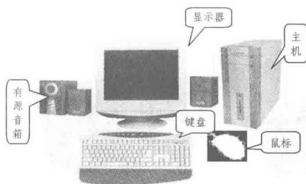
图 1-1 计算机硬件系统的组成
