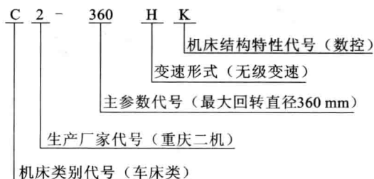
图 1-3 数控车床 C2-360HK 型号中字母及数字含义
