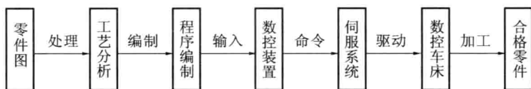
图 1-2 数控车床的工作过程
