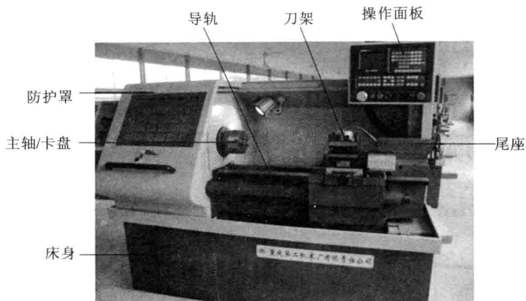
图 1-1 C2-360HK 数控车床结构图
