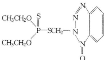
分子式  $C_{12}H_{16}N_3O_3PS_2$ , 分子量 345.4。又名 0, 0-二乙基-S- [(4-氧代-1, 2, 3-苯并三氮杂苯-3 (4 II) -基) 甲基] 二硫代磷酰酸酯、乙基保棉磷、益棉磷、乙基谷赛昂。各硫磷-A。白色针状结晶, 熔点 53℃。沸点 111℃ (0.133Pa)。相对密度 1.284 (20/4℃)。折光率 1.592 8 (25℃)。溶于苯、丙酮; 不溶于水。20℃的蒸汽压为  $3 \times 10^{-5}$  Pa。对热稳定性好, 遇碱易水解。
