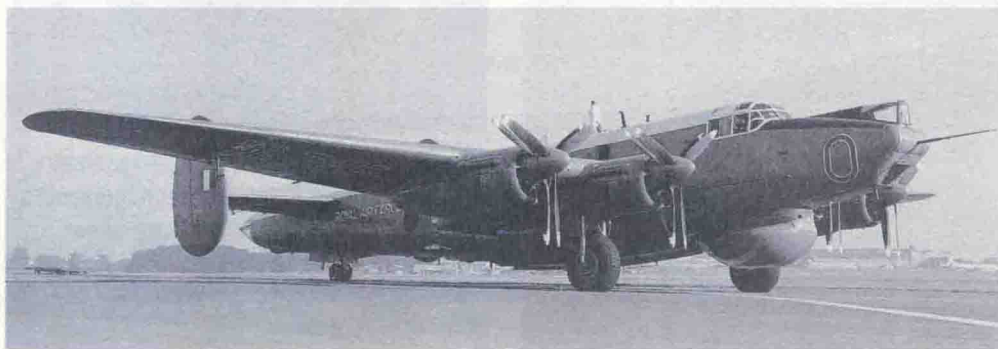
上图：第一架“沙克尔顿” AEW.MK 2预警机于1971年9月30日首飞，它是基于MR.MK 2改装而来的，因为这时较新的MR.MK 3飞机已达到了它的疲劳寿命。
