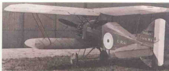
上图: 1919年, 当时名为西德利 S.R.2 的“金丝雀”原型机首次试飞, 其动力装置为全英公司 (A.B.C.) 的“蜻蜓”发动机。1921年, 正式更名为“金丝雀”, 动力装置改用“美洲虎”星形发动机。
