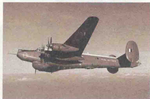
上图：第一架“沙克尔顿” AEW.MK 2预警机于1971年9月30日首飞，它是基于MR.MK 2改装而来的，因为这时较新的MR.MK 3飞机已达到了它的疲劳寿命。
