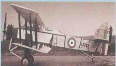
■ APE: 外形不甚美观的 APE 机尾安装角度可调节, 是英国皇家航空研究院的试验机。
