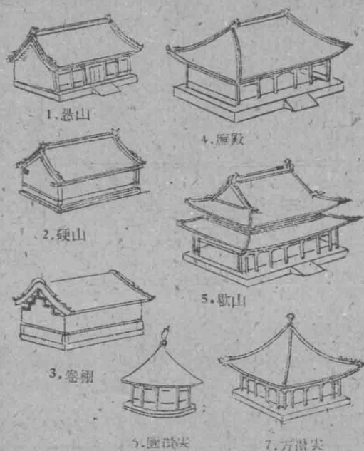
图3-1-11 中国建筑屋顶的样式
