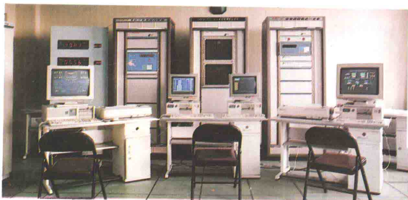
国内首创DSF-1电力系统数字仿真装置及其被测试的保护屏
