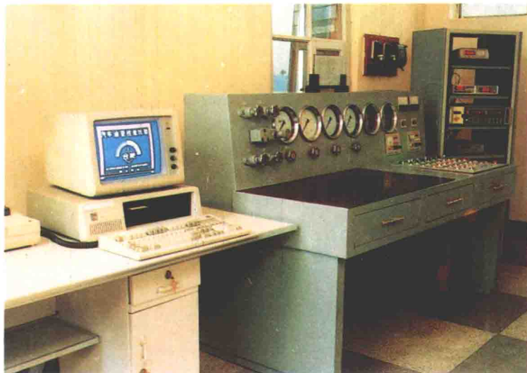
该院液压技术研究所与合肥汽车油泵厂联合开发的YSB—G32计算机控制汽车油泵型式试验台，填补了国内空白。
