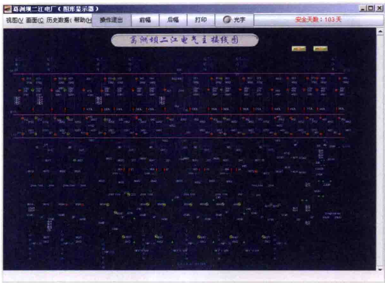
图 1-7 电气主接线监视图
