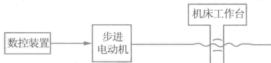
图 1-1-5 开环控制系统框图
