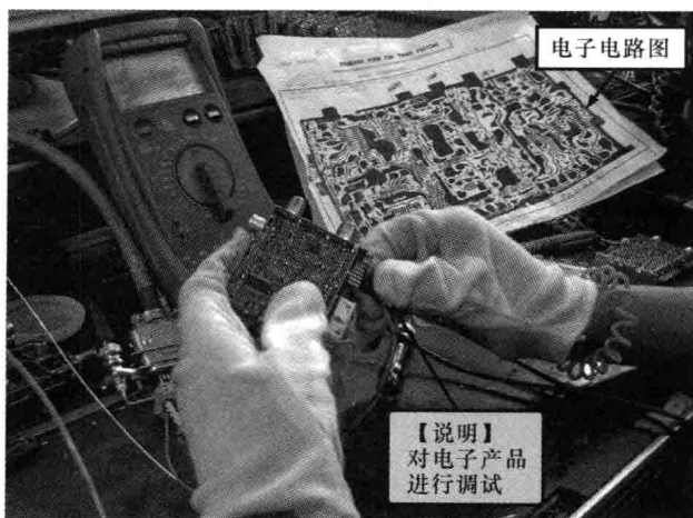
图 1-7 在电子产品生产过程中，调试人员依据电子电路图调试电子产品
