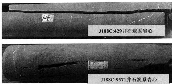
图 0-2 新疆检 188 井区石炭系岩心照片 (示直劈裂缝发育)
