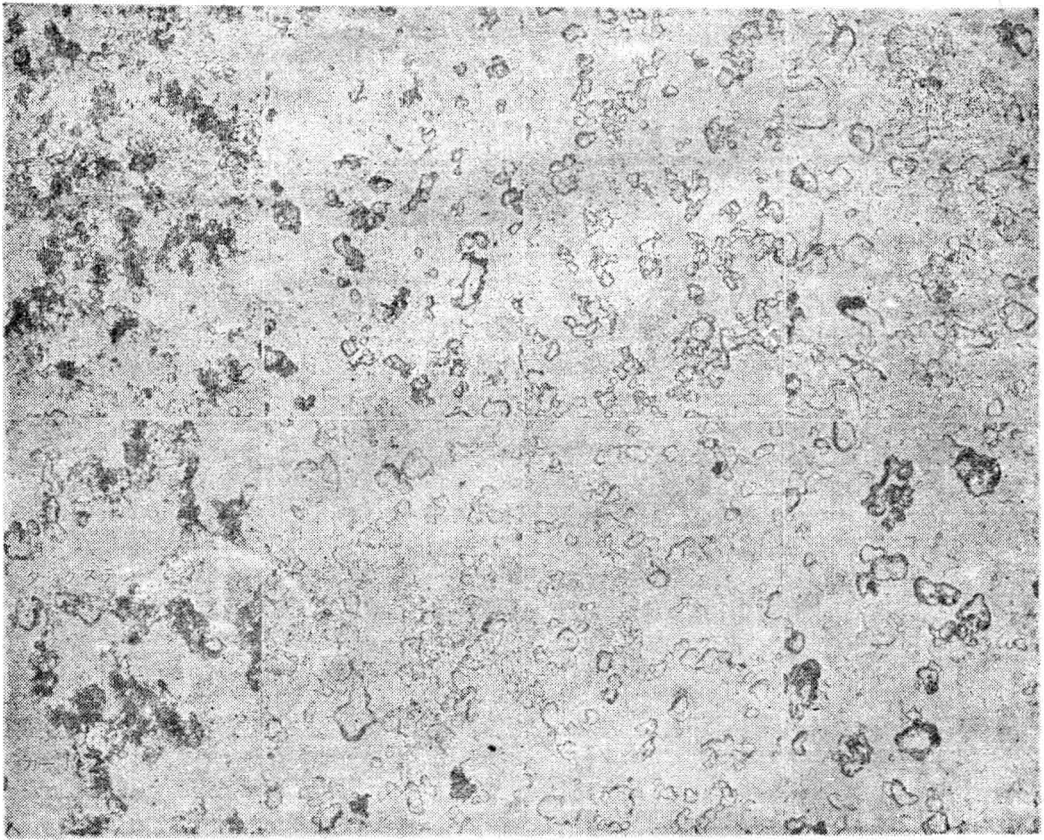
图 10 (G)、(H) W 粉制造的 WC 粉粒度的电子显微镜照片
