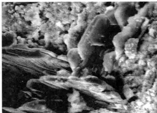
(f) 硅酸盐晶体的细观结构3 (放大1000倍)
