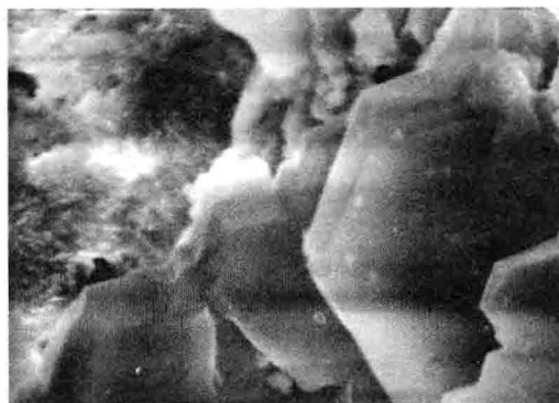
(e) 硅酸盐晶体的细观结构2 (放大1000倍)
