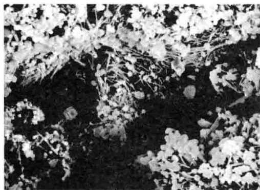
(i) 钙矾石晶体腐蚀后的细观结构 (放大200倍)
