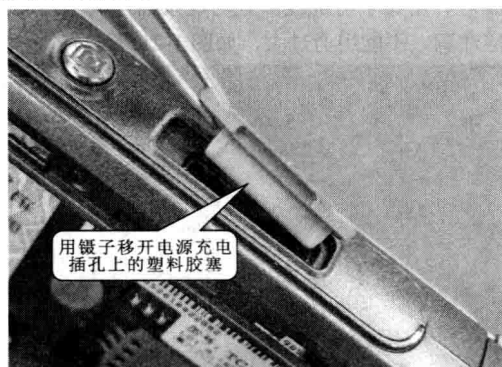
图 1-14 拆卸步骤⑭
