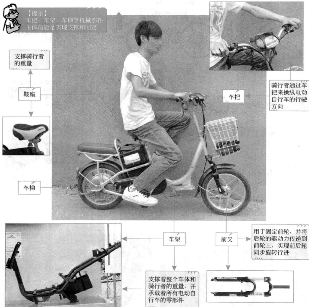
图1-3 典型电动自行车的行车和承重部分
