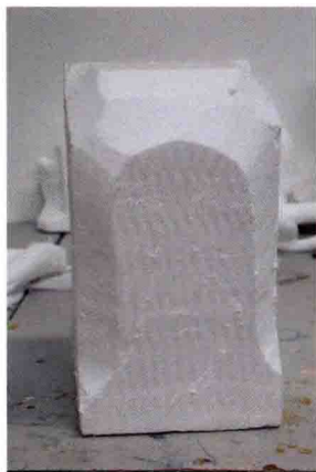
1 先去掉泡沫前端棱角线
