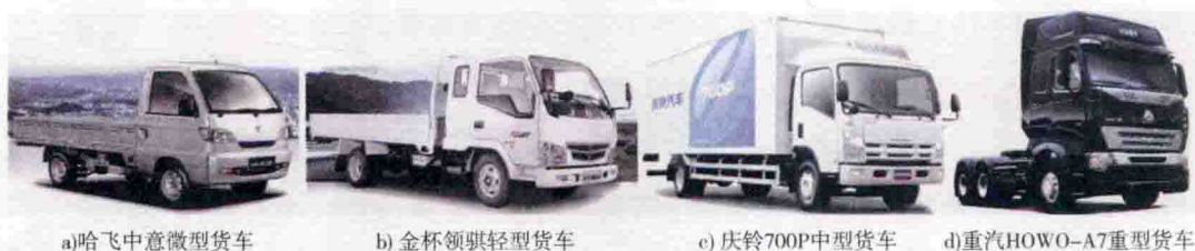
图 1-8 货车分类(按车重)示意图
