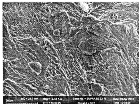
(c)316L 不锈钢疲劳断口形貌
