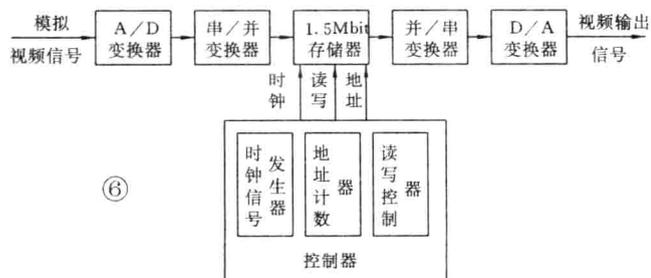
A/D变换器和存储器之间插入串/并变换器(即译码器)。将A/D变换后的信号先经串/并变换及锁存,数据以并行的方式输给存储器,这样降低了对存储器的运算速率要求,反之读出时经并/串变换及锁存再给D/A变换器,恢复成模拟视频信号。
