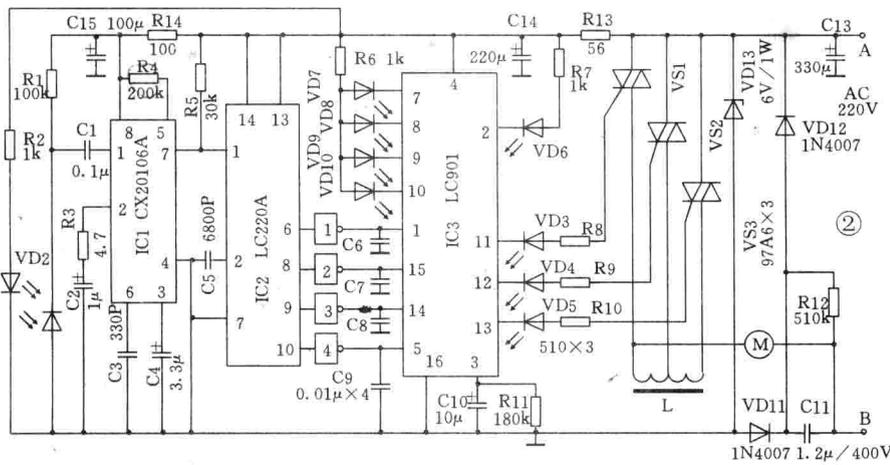
出端,3 脚为内部基准振荡器外接 RC 端,4 脚为电源正端,16 脚为电源负端。
