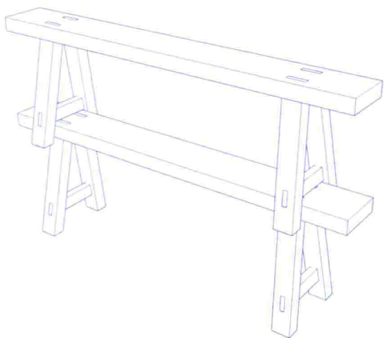
图 1-3 板凳腿面关系构造详图
