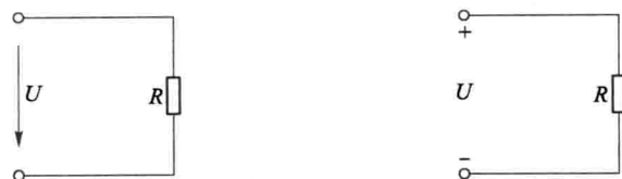
(a) 用高电位点指向低电位点的箭头表示 (b) 高电位点标“+”,低电位点标“-”来表示
