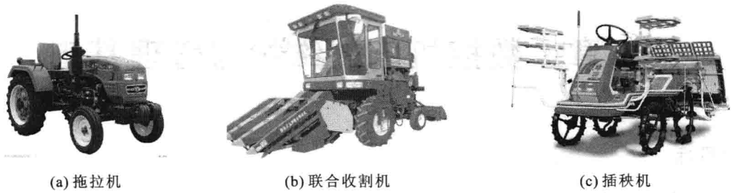
图 1-2 农业生产中常用的机电设备
