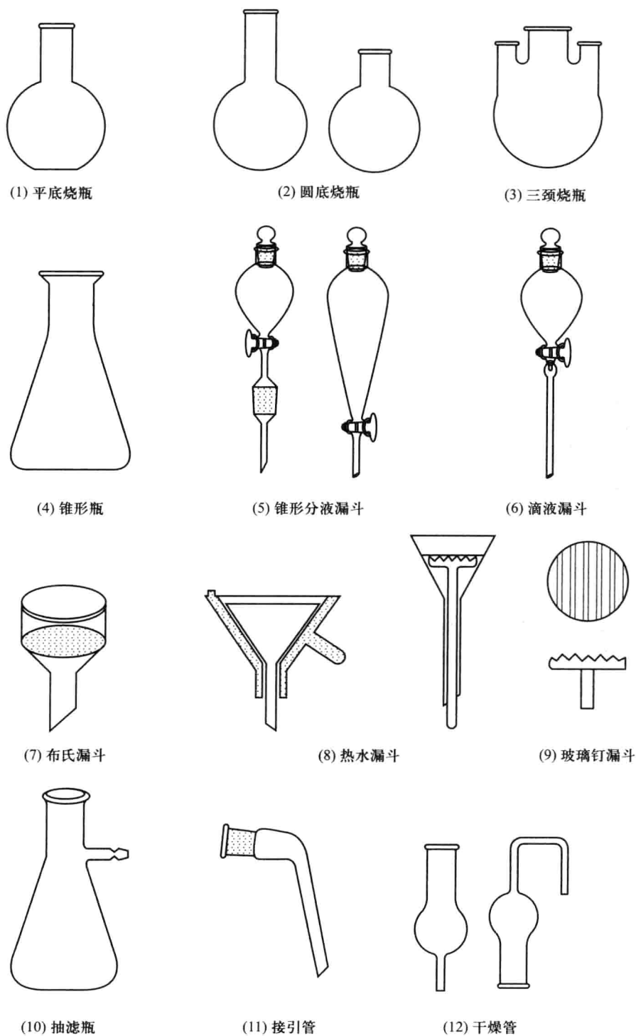
图 1-1 有机化学实验常用普通玻璃仪器
