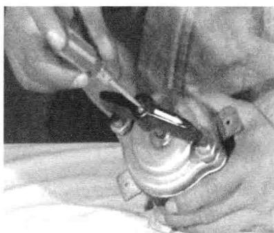
(b) 使用螺丝刀拧小螺钉时的握法
