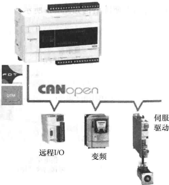
图 2-6 M238 逻辑控制器的 CANopen 总线结构
