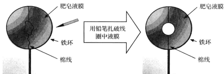
图 2-3 表面张力作用方向示意图
