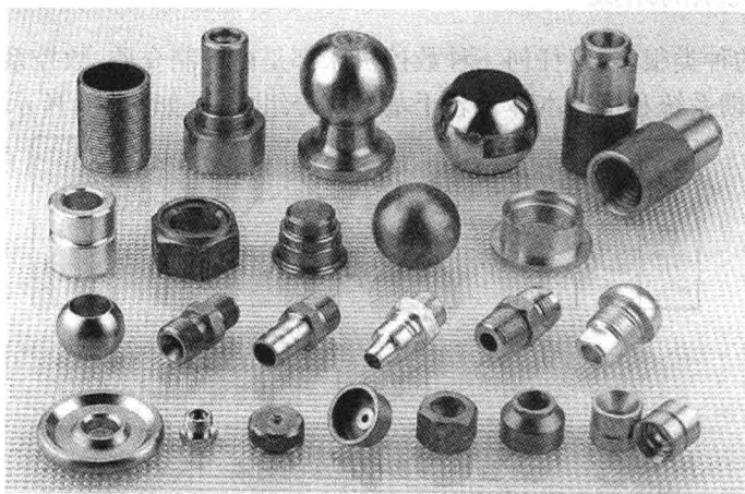
图 1-1 数控车床加工的典型零件
