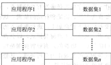
图1-5 人工管理阶段应用程序与数据之间的对应关系
