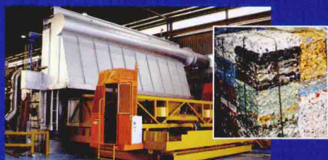
倾动式熔炼炉配备用于7米长挤出型材的上料机
