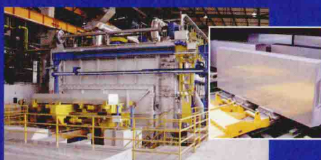
热轧前铸锭加热和均匀化的立推炉
