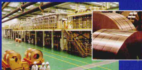
连续带材处理线与水平式气垫炉用于厚带
