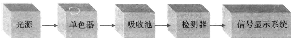
图 1-5 紫外-可见分光光度计基本结构
