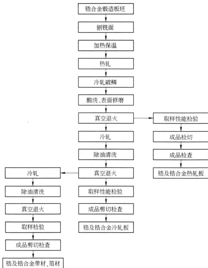
图 11-10 锆及锆合金板、带、箔材轧制工艺流程
