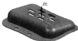
图 1.2 定义后的模具坐标系
