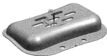
图 1.21 定义模具坐标系
