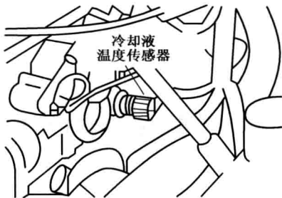
图 1-18 冷却液温度传感器安装位置
