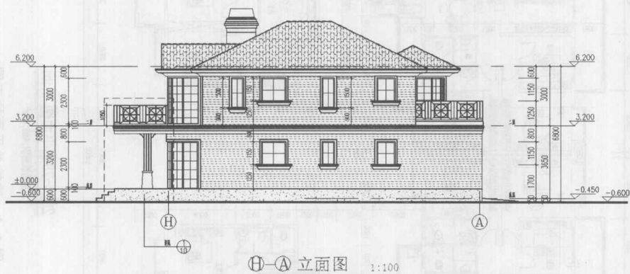
图 1-3 建筑立面施工图
