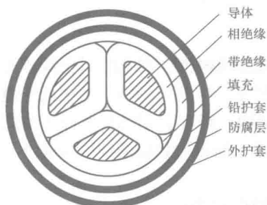
图 2-2 三芯扇形带绝缘电缆结构
