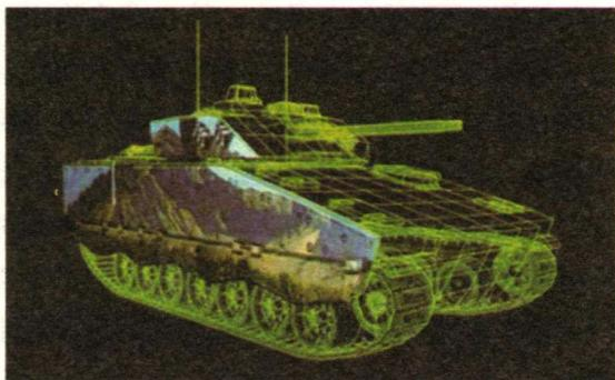
由于现代军事上雷达的广泛使用，使之成为一种重要的探测工具。雷达隐身自然就成为一种重要的隐身技术。雷达发射电磁波，遇到金属目标会发生反射，一部分反射波被雷达接收，目标就被发现了。根据反射波还可以探测出目标的大小和距离。雷达探测目标和目标本身的形式、大小、材料有关系，和雷达探测角度也有关系。为避免雷达波的探测，可以从目标的设计上想一些办法，使它尽量减少雷达波的反射。回
