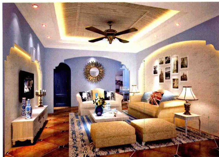
石膏板造型暗藏灯带
