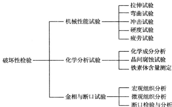
图 0-3 破坏性检验的项目
