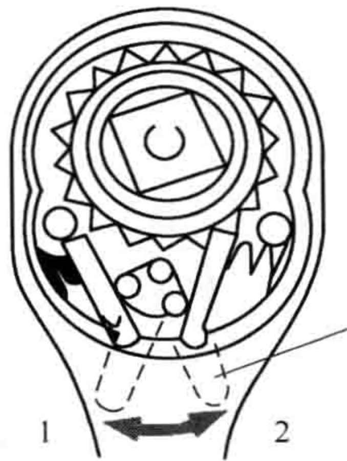
图 1-19 棘轮的换向功能 1—拧松；2—拧紧
