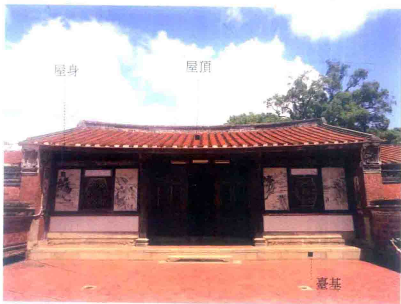
▲圖17-1 民居建築的構成圖（楊博淵改繪）
