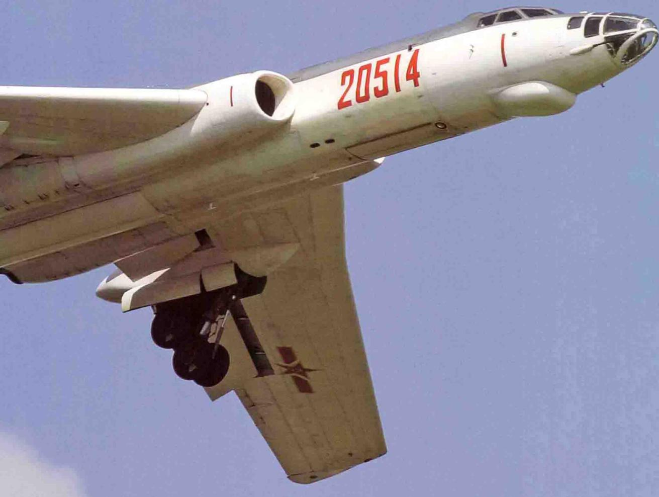
H6是中国西安飞机工业集团公司在苏联图-16轰炸机的基础上研制的双发涡喷中型轰炸机，主要用于搭载常规炸弹和核弹执行临空轰炸任务，经过改进后可执行反舰、防区外打击和空中加油等任务。
