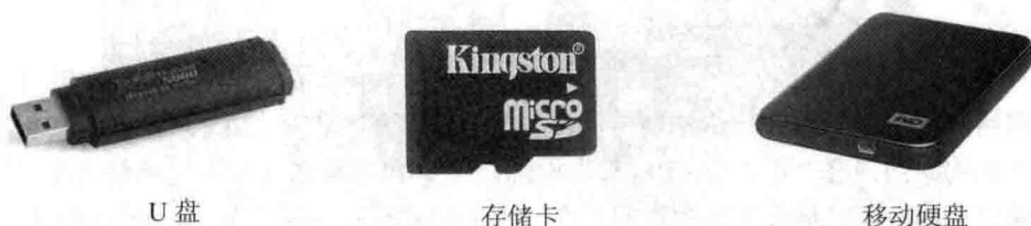
图 1-8 移动存储设备
